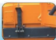
Déclenchement par le bas avec système à ressort
