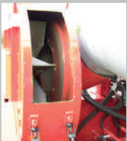
Fenêtre d'inspection turbine
