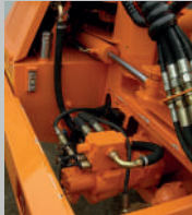
Pompe à piston en circuit ouvert
